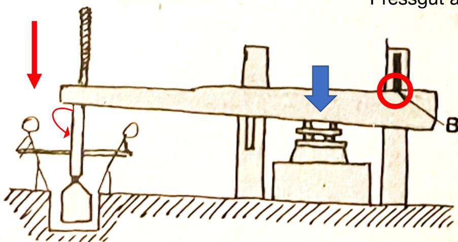
Der Drehpunkt wird nach B gewechselt. Durch Schrauben nach unten wird der gesamte Baum gesenkt und erzeugt zusätzlichen Druck auf das Pressgut.
