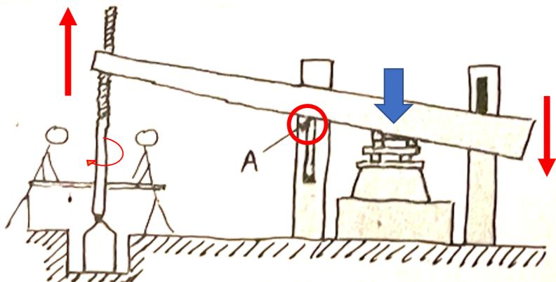
Durch Schrauben nach oben um den Drehpunkt A wird der Baum über dem Pressgut abgesenkt
